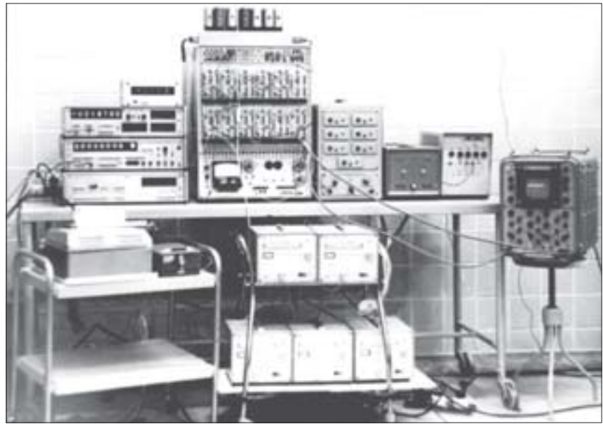
Рис. 1. Коррелятор ЭЭГ на базе аналоговой вычислительной машины АВМ МН-10. (Отдел возрастной физиологии, НИИ охраны здоровья детей и подростков, Харьков, Украина. 1976. Диплом ВДНХ СССР за 1984 г. (фото из архива профессора О. Ю. Майорова)
