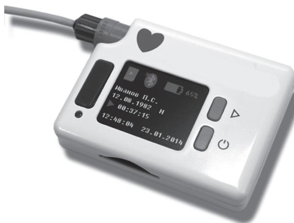
Рис. 1. Портативный регистратор ЭКГ и ФПГ сигналов.
