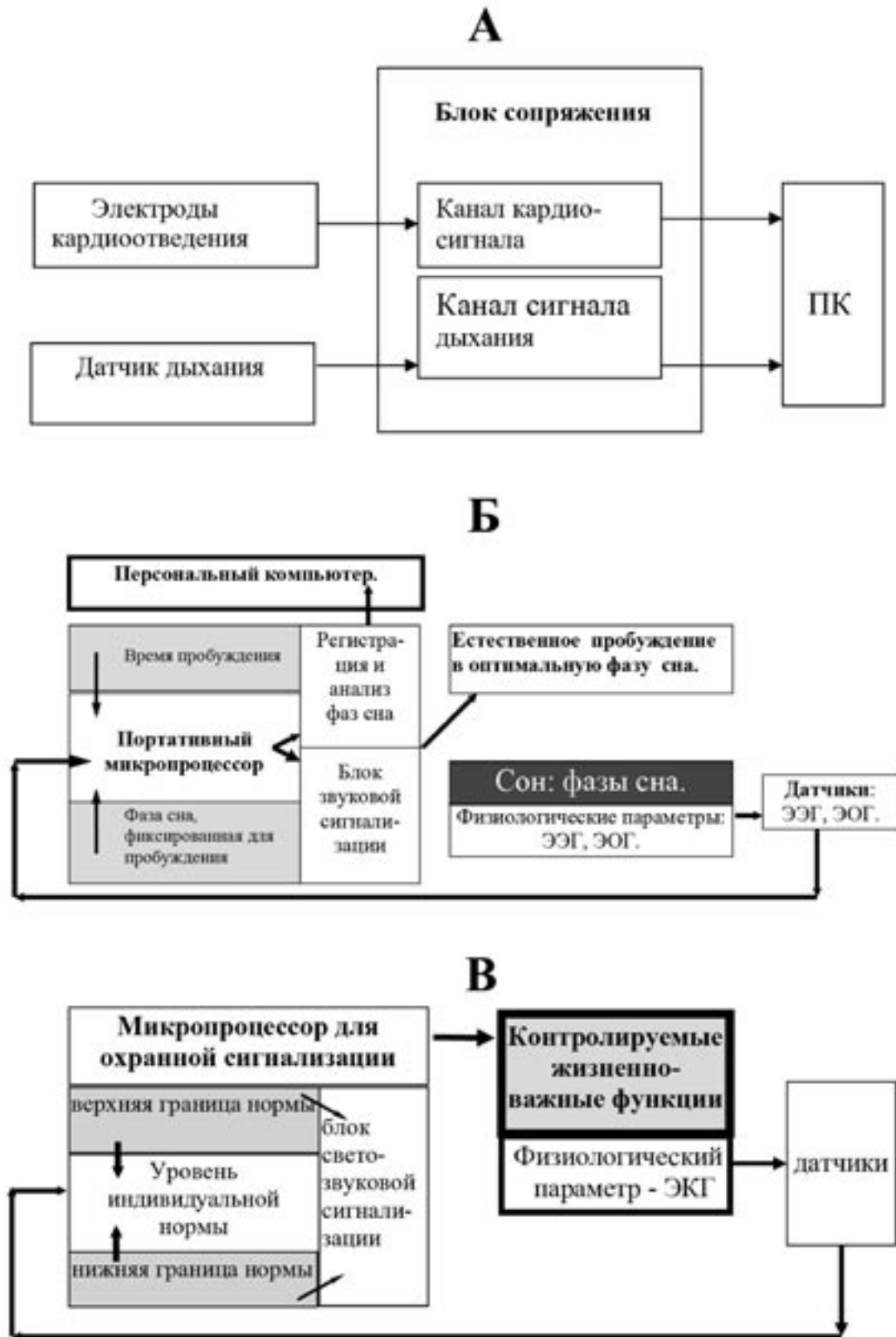
Рис. 1. Структура информационно-аппаратурного комплекса для контроля физиологических функций во время повседневного ночного сна. А. Блок вариационного и корреляционного анализа сердечного ритма и частоты дыхания. Б. Блок контроля и анализа фаз сна, пробуждения в выбранную фазу сна прерывания опасной фазы сна. В. Блок охранной сигнализации нарушения сердечного ритма.
