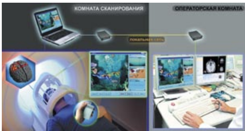
Рис. 1. Схема конструкции экспериментов по произвольному управлению частотой сердечных сокращений игровым виртуальным сюжетом «Вира!». Формирование зон активности и их сканирование во время управления игровым сюжетом. Регистрирующий ноутбук и компьютеры оператора объединены в локальную сеть посредством оптического кабеля. Монитор, отображающий игровой сюжет, расположен позади магнита. Головная приемно-передающая катушка с косым зеркалом обеспечивает видимость экрана испытуемому. Регистрация пульса осуществляется беспроводным пульс-детектором.
