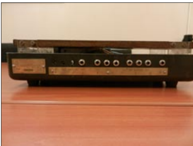
Рис. 1. Первый советский баллистокардиограф (слева), использовавшийся для массовых обследований населения в 50–60-е годы прошлого века. Справа детали конструкции прибора.
