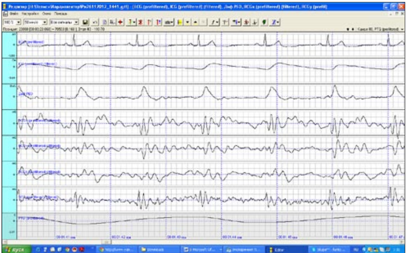
Рис. 7. Образец записи комплекса кардиологических параметров с помощью бортового прибора «Кардиовектор» (сверху-вниз: ЭКГ — электрокардиограмма, ИКГ и ИПГ-1П — импедансная кардиограмма и ее первая производная, БКГ X, Y, Z — пространственная баллистокардиограмма по трем линейным осям X, Y, Z; СКГ — сейсмокардиограмма, ПТГ — пневмотахограмма).
