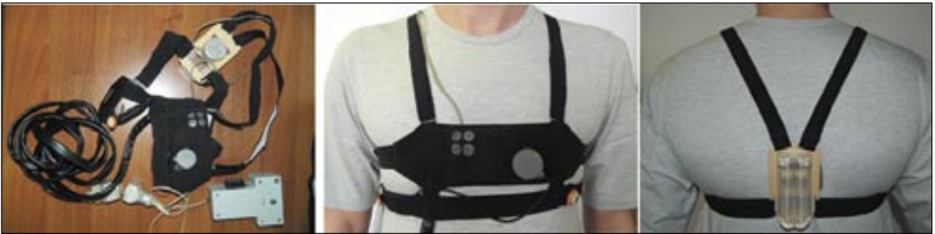
Рис. 4. Космический эксперимент «Вектор». Дополнительный блок к аппаратуре «Гамма» (слева), нагрудный пояс с электродами для ЭКГ и датчиком СКГ (в центре), трехмерный акселерометрический датчик для регистрации пространственной БКГ (справа).
