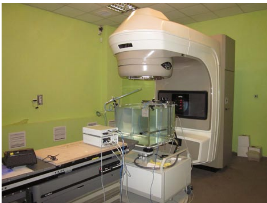
Рис. 4. Вимірювальний комплекс для дослідження дозиметричних характеристик лінійного прискорювача електронів Clinac 600C.
